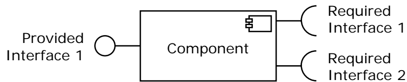
Abbildung 2.1.: Einfache Komponente mit einer angebotenen und zwei benötigten Schnittstellen
